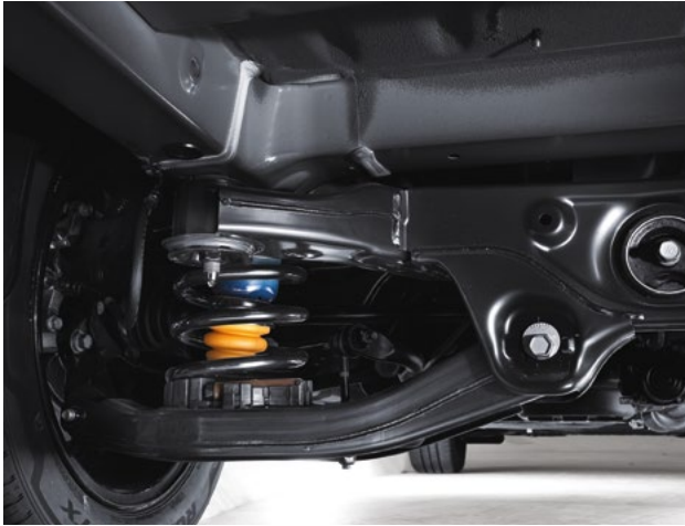
Багатоважільна підвіска Технічне вдосконалення забезпечує підвищений комфорт їзди завдяки застосуванню багатоважільної підвіски на задній осі.
